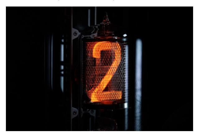
Im Herzen dieser ausgefallenen Uhr befindet sich eine schillernde und fast nostalgische Hommage an die Nixie-Röhren. Die in den 1950er-Jahren eingeführten Nixie-Röhren setzten sich schnell als beliebtes Mittel für die Anzeige von Formen dank einer Glimmentladung durch.
