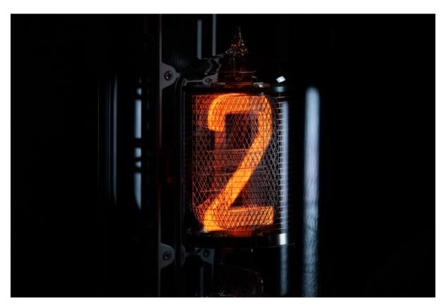
В основе этих незаурядных часов — мерцающая и едва ли не ностальгическая дань уважения газоразрядным индикаторам, известным как «трубки Nixie». Введённые в обиход в 50-х годах, трубки Nixie быстро завоевали популярность как средство отображения информации с помощью тлеющего разряда.
